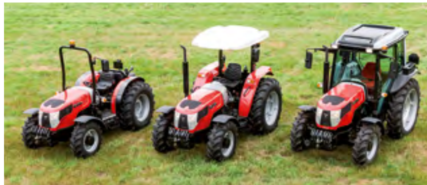
De små A-serie traktorerne fås med både smalle og bredere sporvidde og kan have en åben kabine, kabine med aftageligt tag eller en lukket kabine.
