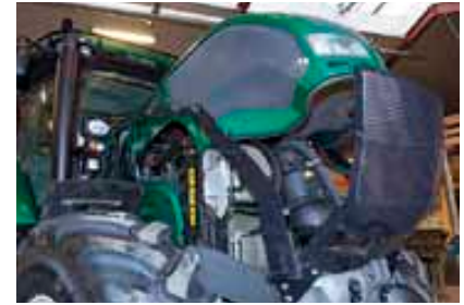
Motorhjelm kan åbnes, så der er god adgang til kølere med videre.
