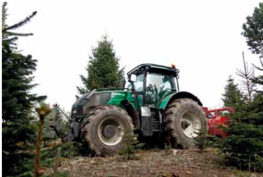
Her er traktoren i gang med at knuse juletræer og afhuggede grene. Læg mærke til skovinddækningen, som er udført af Schrøders Maskinfabrik.
