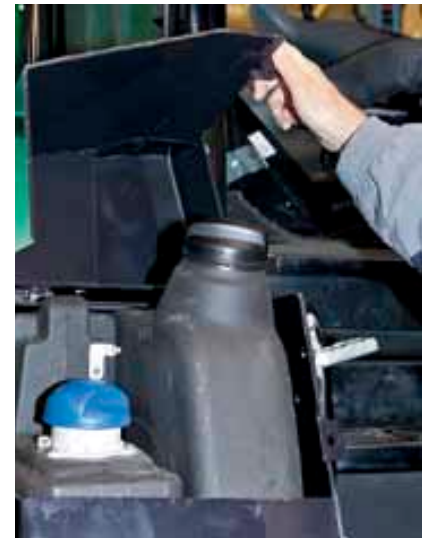
Under dækslet er der nem adgang til at påfylde diesel og AdBlue.
