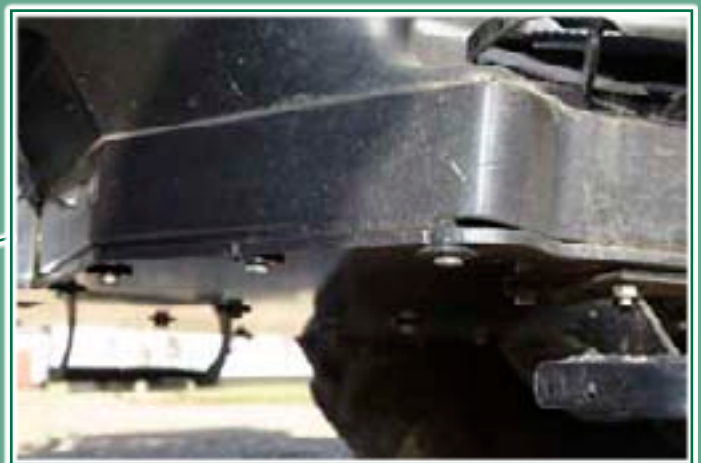
Hele bunden er godt beskyttet af en tyk stålplade.
