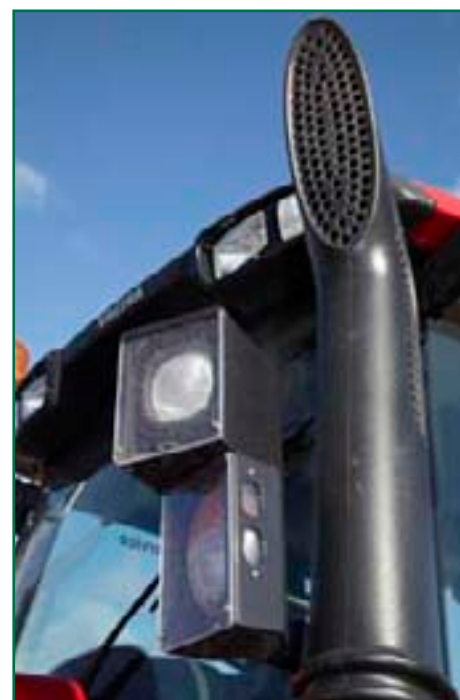
De ekstramonterede Xenon lygter er godt pakket ind, så de ikke ødelægges under arbejdet.
