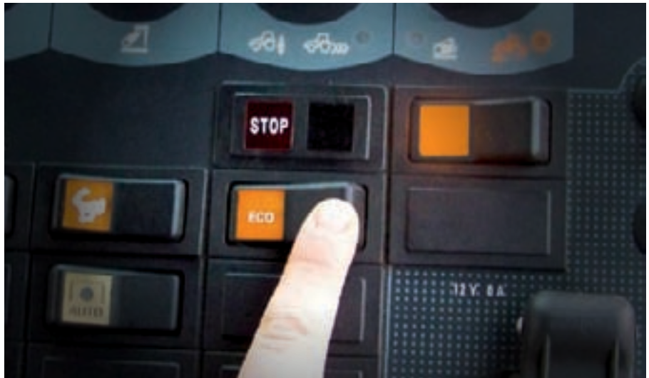
Ved hjælp af en simpel kontakt kan man spare 10–15 procent brændstof.
