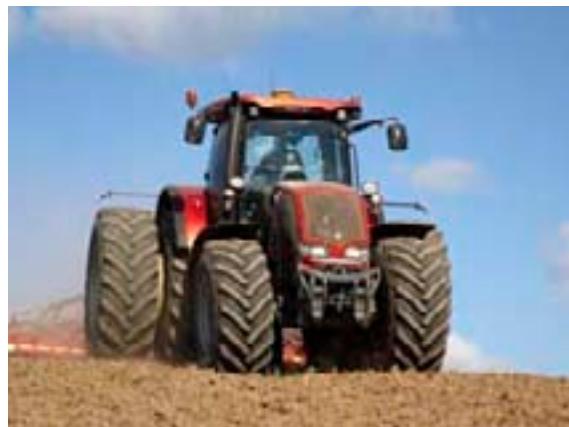
Såning sker efter opharvning, og der er monteret tvillinghjul for at sænke marktrykket.
