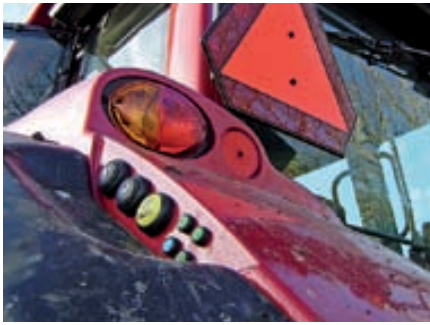
God detalje med betjeningsgreb til både lift, pto samt hydraulik på bagskærmene. De sidder dog temmelig højt placeret, så de ikke er til at nå fra liften.
