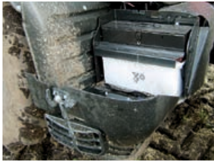
Det nye design har desværre gjort, at værktøjskasse er gemt godt af vejen under trinbrættet i højre side på Versuen.
