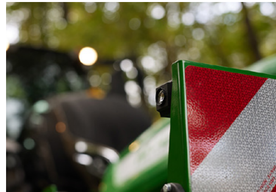
Kameraet er her monteret på en frontskårlægger, men i princippet kan det monteres på et hvilket som helst frontredskab.
