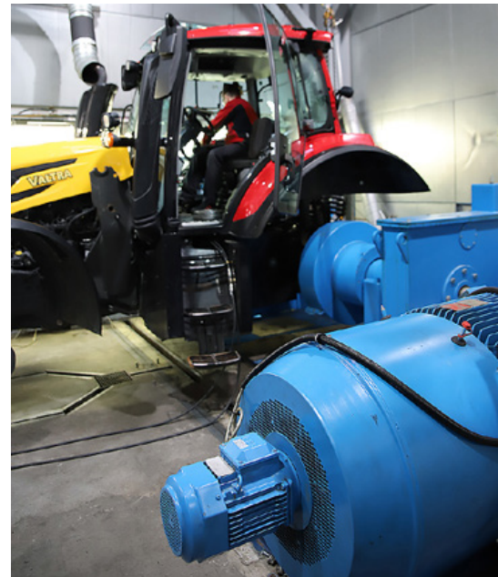
Jan-Erik Karjula betjener en traktor på teststanden. Resultaterne vil blive brugt til videreudvikling af både traktorer og simulatorer.
