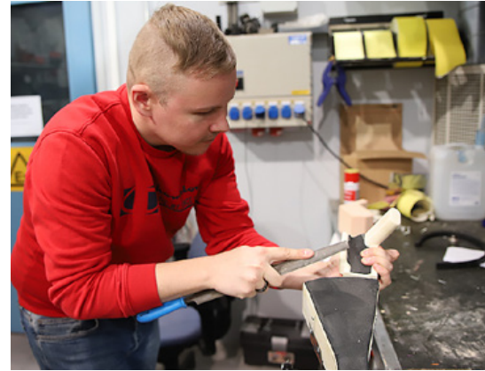
Industrial Designer Henri Hokkanen arbejder på en plastmodel af et armlæn. Der bliver brugt en masse plast, træ og 3D-printede komponenter i designstudiet for at udarbejde testmodeller i fuld størrelse af fremtidige traktorer og førerhuse.
